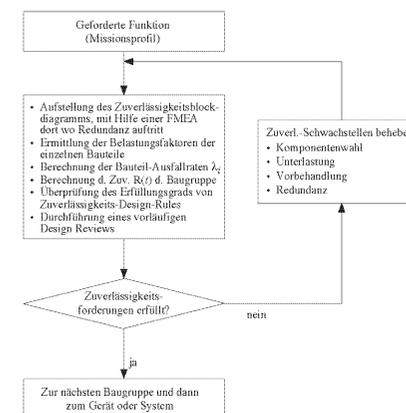
Bild 1 Prozedur für die Zuverlässigkeitsanalyse einer Baugruppe [2, 3]
